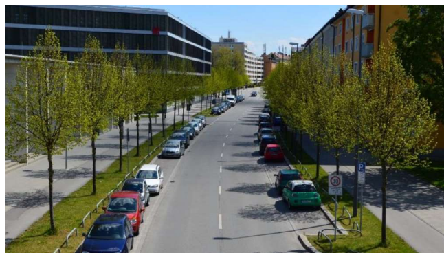
Výsadba uličního stromořadí do otevřeného travnatého pásu s dostatečným prokořenitelným prostorem.
