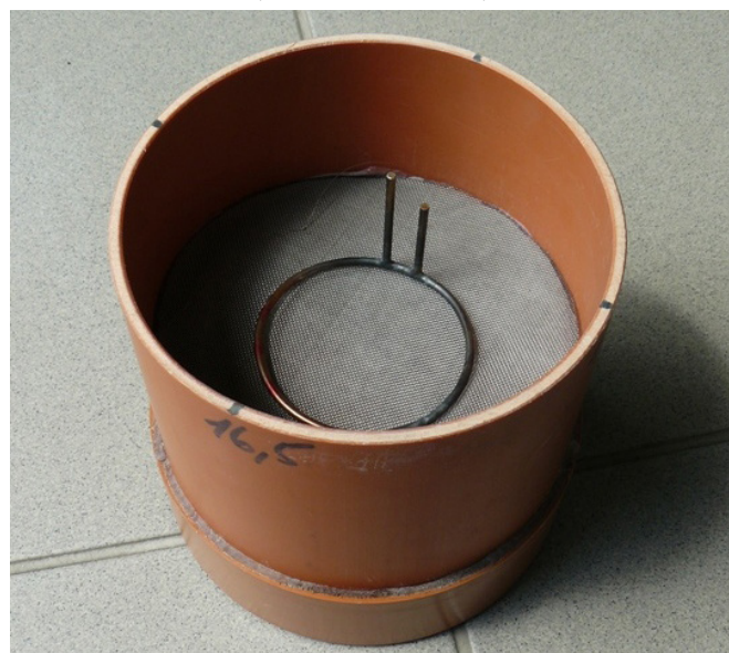
Obrázek 10: Stanovení rychlosti infiltrace vody
